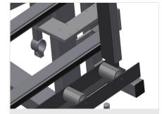
**Barre di serraggio** Centraggio pneumatico. Precisione grazie alla pressatura parallela delle barre di
