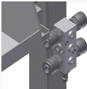
**Attacco dell'aria compressa quadruplo**
