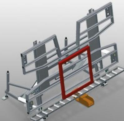
Banco di montaggio per il montaggio verticale e orizzontale
