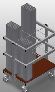
Carrello per il trasporto e la disposizione classificata di profili di armatura ritroncati
