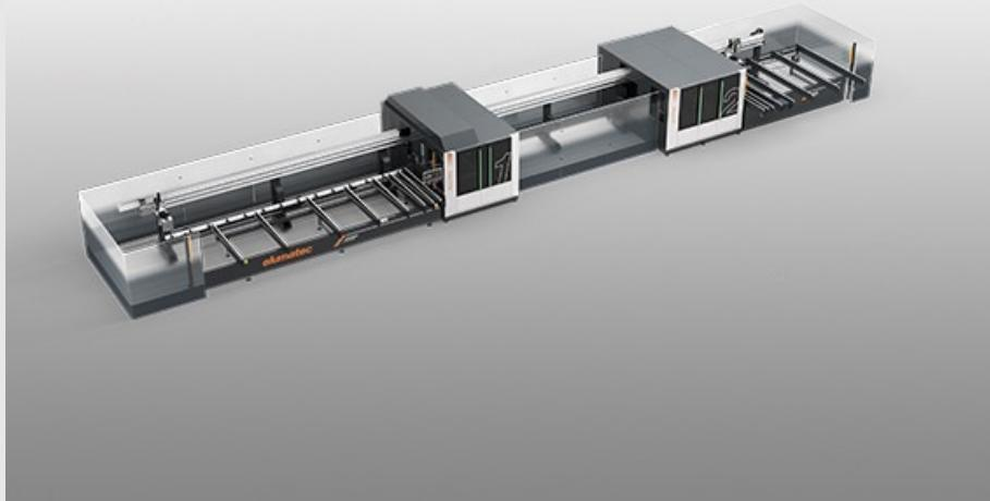
这款先进的自动铝材加工中心 SBZ 625/13 为用户提供了无与伦比的精度和灵活性。该加工中心配备多达 40 个轴，坚固耐用，功能强大。无论是铝材标准型材还是门窗型材的加工，都能够轻松实现。并行的加工步骤大大缩短了生产时间，直观的操作界面确保了操作的简便性。
