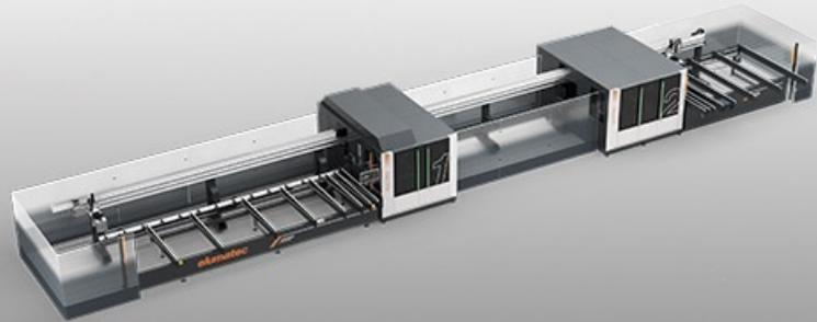
这款先进的自动铝材加工中心 SBZ 625/13 为用户提供了无与伦比的精度和灵活性。该加工中心配备多达 40 个轴，坚固耐用，功能强大。无论是铝材标准型材还是门窗型材的加工，都能够轻松实现。并行的加工步骤大大缩短了生产时间，直观的操作界面确保了操作的简便性。
