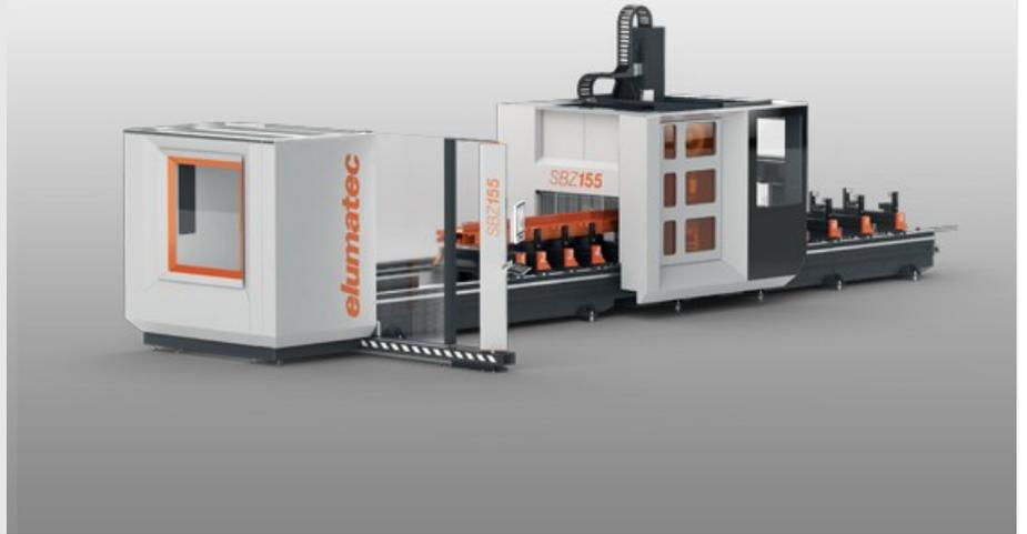
能够满足最高要求的5轴型材加工中心，首次采用龙门式设计构造：作为elumatec全新的顶级产品，SBZ 155型材加工中心将无以伦比的性能参数与开创性的设计合二为一。紧凑、灵活、快速：SBZ 155是铝合金、薄壁钢型材全自动CNC加工中心的里程碑、特别是其6面加工功能以及节省空间的可选配龙门驱动器。由于SBZ 155缩短了刀具换装时间，因此能够保证理想的加工循环，并且该款机床还具备极高的灵活性，因此金属加工以及工业领域的用户将会从中受益。大尺寸随动刀库可装备14个标准型刀具。依据不同的配置，还可配备最多六个特殊刀具以及两个直径为200或550 mm的锯片。龙门式设计和2个加工区域能够容纳和通过横截面最大高达1,000 x 380 mm的型材以及在穿梭式加工中的灵活作业。依据elumatec客户的单独要求，SBZ 155还可增加为数众多的选配项目。从双侧自动长度测量到二维码扫描，不会让您的任何愿望落空。此外，这一全能型设备也同样可以使用eluCloud，因此符合工业4.0的要求。
