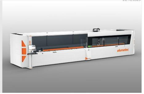
节省时间,节省空间,降低成本: SBZ 125/85型材加工中心为全封闭舱式机床,有效长度达八米,具有五个轴,其动态穿梭式加工可取代两台小型机床。在广受好评的SBZ 122/75基础上进一步开发的过程中,elumatec充分考虑了客户的反馈意见,将人体工学设计、可触及性以及备料时间进行了优化。在加工铝合金、塑料以及薄壁钢型材时,该新款机型更加经济,更加合理。
