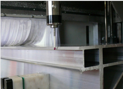
在工作过程中用无线探头进行测量
