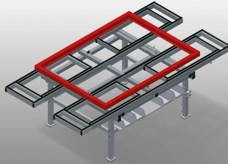
用于在框架和窗扇上进行加工作业的可抽拉组装工作台
