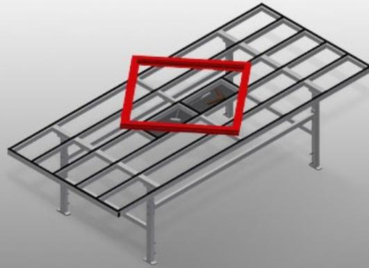
用于在框架和窗扇上进行加工作业的可抽拉组装工作台
