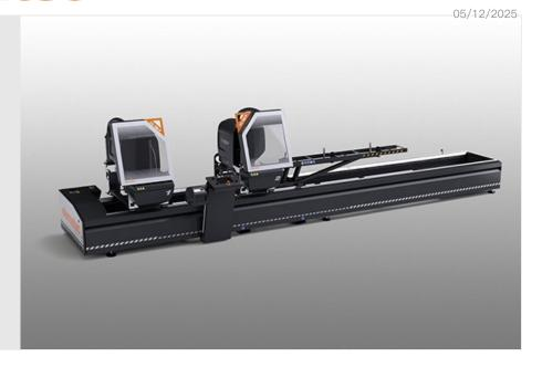
电子双头切割机配有数控控制的移动切割头无刷电动机自动移动装置。在两个固定位置上通过气动装置倾斜切割单元、角度范围 90°至 22°30′(外侧)、或者采用选配的中间角度机械调节系统。气动油压刀片进给。
