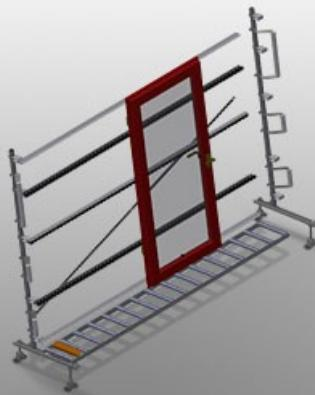
Вертикальный рольганг для транспортировки и хранения оконных элементов
