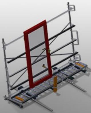
Вертикальный рольганг для транспортировки оконных элементов
