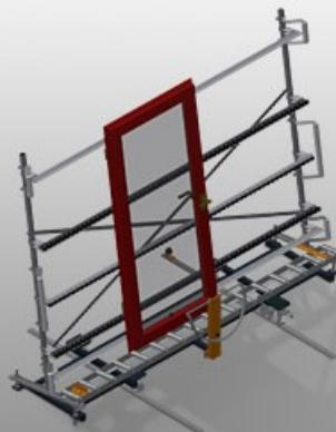
Вертикальный рольганг для транспортировки оконных элементов
