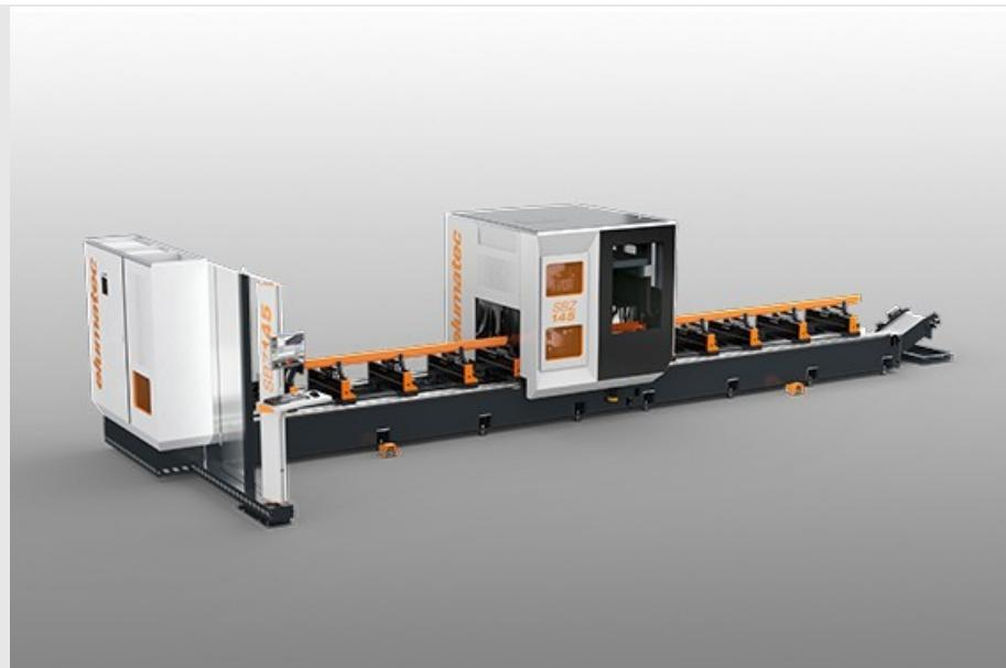
SBZ 145 с 5 осями обработки разработан с учетом требований металлообрабатывающей отрасли и промышленного применения и имеет зону обработки 560 мм x 350 мм x 7500 мм. Станок оснащен автономной осью прижимов и вместительным магазином для фрез, сверл, метчиков и пильных дисков. SBZ 145 подходит для самых разных вариантов обработки: от обработки и распила профильной заготовки до обработки предварительно распиленных одиночных деталей в опциональном членочном режиме (2x 3250 мм).
