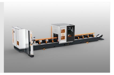
SBZ 145 с 5 осями обработки разработан с учетом требований металлообрабатывающей отрасли и промышленного применения и имеет зону обработки 560 мм х 350 мм х 7500 мм. Станок оснащен автономной осью прижимов и вместительным магазином для фрез, сверл, метчиков и пильных дисков. SBZ 145 подходит для самых разных вариантов обработки: от обработки и распила профильной заготовки до обработки предварительно распиленных одиночных деталей в опциональном челночном режиме (2х 3250 мм).
