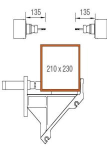
**Область обработки по оси Y и Z**
