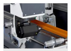
Регулировка угла с помощью оси А
