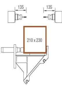
**Область обработки по оси Y и Z**
