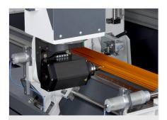
Регулировка угла с помощью оси А
