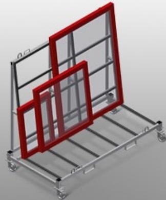
Тележка для внутрипроизводственной транспортировки оконных элементов
