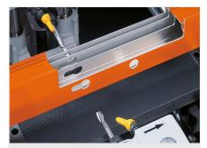
Двухшпиндельный копировально- фрезерный станок KF 78/23
