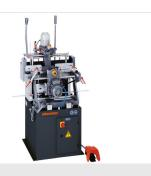
Двухшпиндельный копировальнофрезерный станок КF 78/23
