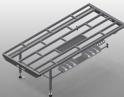
Модульный рабочий стол для производственной линии (основной модуль)
