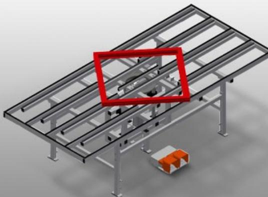
Подъемно-поворотный стол для монтажа и заправки уплотнителя. Прочная стальная конструкция. Идеальное решение для монтажа и заправки уплотнителя. Может регулироваться по высоте. Пневматическая регулировка высоты внутреннего стола. Поворотный внутренний стол с пневматическим стояночным тормозом. Внутренний стол с резиновыми планками. Наружный стол с пластиковыми направляющими. Пневматическое соединение на 4 штуцера.
