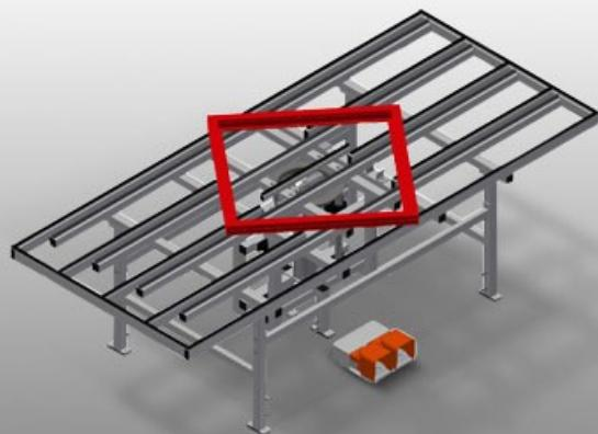
Подъемно-поворотный стол для монтажа и заправки уплотнителя
