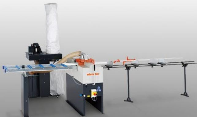
Пила для V-образных резов оборудована 2 пильными дисками для распилов под углом 45°
