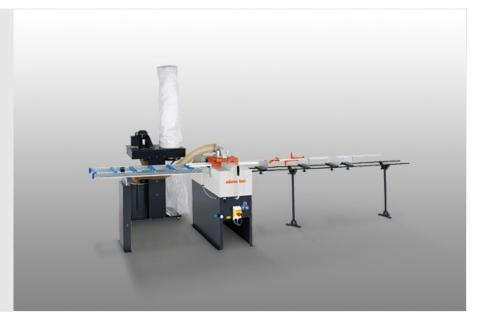
Пила для V-образных резов оборудована 2 пильными дисками для распилов под углом 45°
