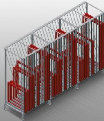
Стеллаж для хранения оконных элементов. Прочная стальная конструкция. Вертикальный накопительный стеллаж для сортировки элементов створок. Накопительный стеллаж с 10 отсеками. Быстрый доступ к элементам. Разделительные трубы между отсеками с пластиковым покрытием. Опорная поверхность с пластиковой плитой. Специальная опора с направляющим листом обеспечивает эргономичное извлечение элементов створок в соответствии с фактической потребностью.
