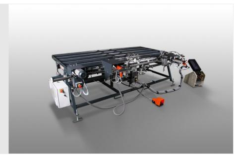
Центр сборки створок для монтажа фурнитуры на пластиковых и алюминиевых оконных створках
