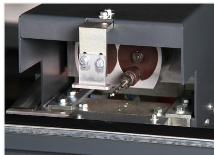
**Устройство сверления отверстий под угловые петли**
