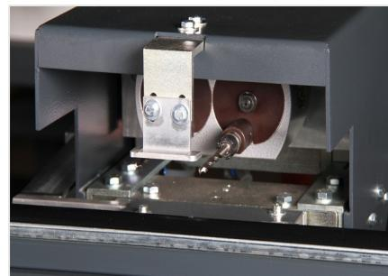
**Устройство сверления отверстий под угловые петли**
