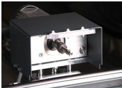
**Устройство фрезерования замкового паза**
