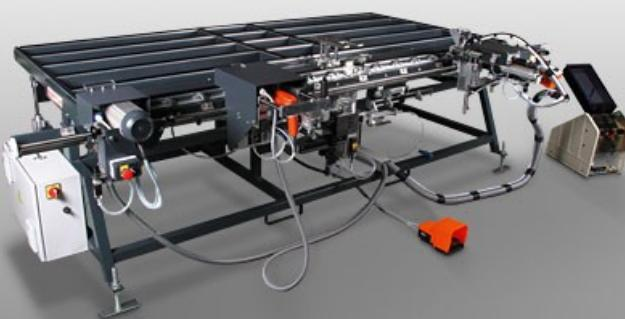
Центр сборки створок для монтажа фурнитуры на пластиковых и алюминиевых оконных створках
