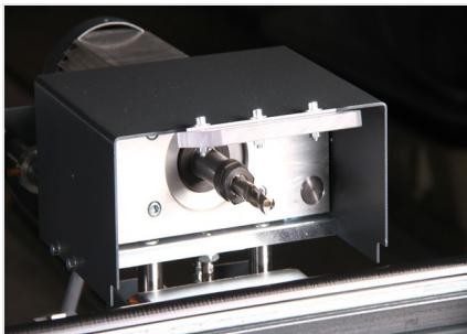
**Устройство фрезерования замкового паза**
