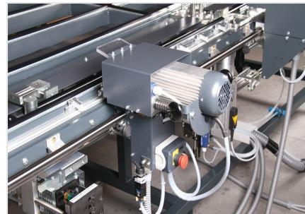
**Пневматическая регулировка высоты корпуса замка**
