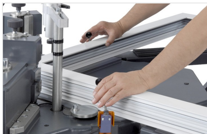
Пресс для стыковки углов EP 124/20
