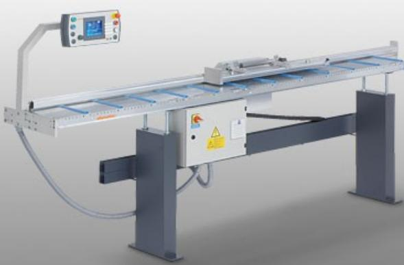
Упорно-измерительная система с автоматической регулировкой длины реза и системой управления позиционированием Е 355
