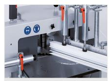
Фрезерный станок для фрезерования торцов AF 222/02
