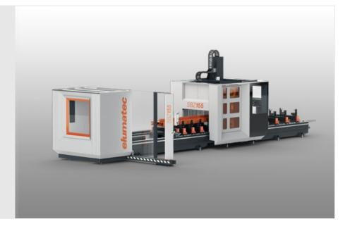
Maquinação de perfis de 5 eixos para os requisitos mais elevados, pela primeira vez na conceção de portais: Sendo um novo modelo de topo elumatec, o centro de maquinação de barras SBZ 155 combina parâmetros de desempenho anteriormente inatingidos com um design inovador.
