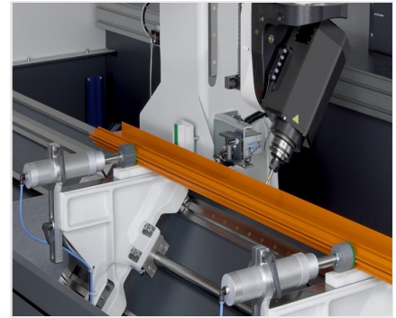
Centro de maquinação de perfis SBZ 122/74
