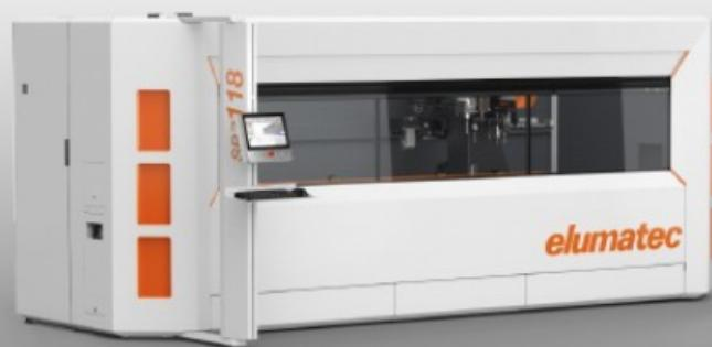
**A SBZ 118, um centro de maquinação de perfis de 3 eixos com maquinação opcional de 5 lados, fácil de utilizar e com uma área de ocupação mínima, expande o gama elumatec de produtos de nível básico para maquinação CNC automática de perfis de alumínio, PVC e aço de paredes finas. Com a sua maquinagem de três metros de comprimento, este modelo versátil e potente é a máquina CNC mais compacta da actual gama elumatec.**
