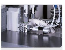
Máquina de corte automática SA 142/37
