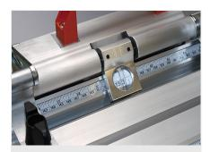
Sistema de batente e medição MMS 100
