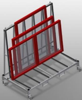
Carro de comissionamento para o transporte de elementos de janelas dentro da empresa e por camiões
