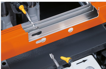
Fresa-copiadora de 3 cabeças KF 178/10
