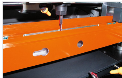
Fresa-copiadora de 3 cabeças KF 178/10
