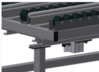
**Dispositivo de elevação pneumático**
