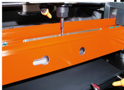
Dwuwrzecionowa frezarko-kopiarka KF 78/23
