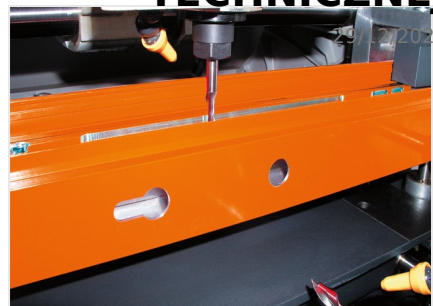
Trójwrzecionowa frezarko- kopiarka KF 178/10
