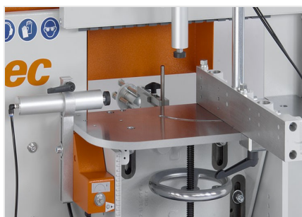
Frezarka do słupków AF 223/01
