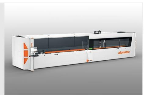
SBZ 125/85 è un centro di lavoro a 5 assi realizzato per lavorare profili in alluminio, PVC e acciaio a parete sottile. La lunghezza di 8 metri permette di lavorare sia in modalità pendolare sia in tutta la lunghezza.
