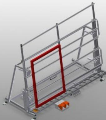
Banco di montaggio per il montaggio verticale
