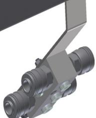
**Attacco dell'aria compressa quadruplo**
