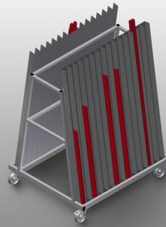
Carrello per fermavetri per il trasporto e la classificazione di fermavetri
