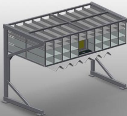
Scaffale ferramenta con 36 scomparti per il riponimento ordinato delle ferramenta sulla postazione di montaggio delle ante
