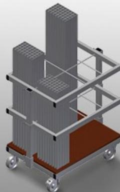
Carrello per il trasporto e la disposizione classificata di profili di armatura ritroncati
