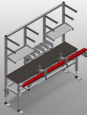
Table d'assemblage pour le prémontage de ferrures et des joints
