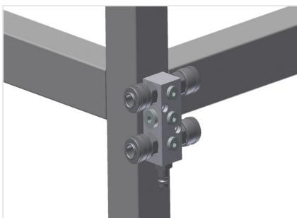
**Raccord d'air comprimé quadruple**
