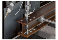
Centre d'usinage de barres SBZ 130 eluCam
