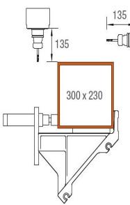
**Zone d'usinage axes Y et Z**
