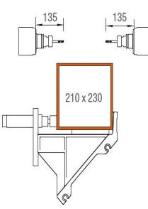
**Zone d'usinage axes Y et Z**
