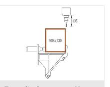
Zone d'usinage axes Y et Z
