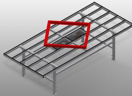
Table d'assemblage extensible pour tous les travaux sur le cadre et le vantail
